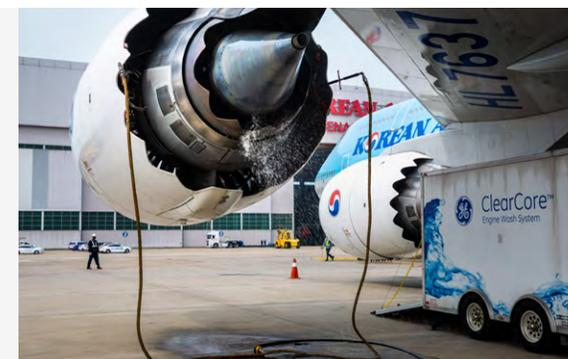
Engine Water Wash는 항공기 엔진 연소실 및 압축기 내 이물질 제거하여 엔진 내부의 공기 흐름을 원활히 해 연소 효율을 높이는 기술로, 특히 대기중 미세 오염 농도가 높을 때 효과가 높습니다. 항공기 엔진 세척은 물탱크 차량을 이용하여 적절한 압력의 물로 세척하는 것이 보편적이며, 겨울철에는 결빙을 방지하기 위해 인증된 왁스류를 사용해 건식 세척을 진행하고 있습니다.
